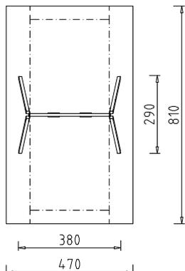
Beschreibung: 4 Schrägstützen aus KH 11/11 cm, 1 Schaukelbalken 3,0 m aus Stahlrohr 100/100/4 mm, verzinkt, mit Flanschplatten 8mm für die Stützen, 2 Abhängungen, 2 Sicherheitsschaukeln standard. Aufständerung mit 4 Stk. Doppellaschen. Fundamente: 4 Stk. 50x50x50 cm Gewicht: 250 kg, schwerstes Teil: 50 kg
